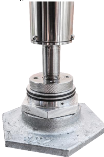
Figura 9 - Flange de 2" rosqueada, e sonda encostando no fundo do tanque
