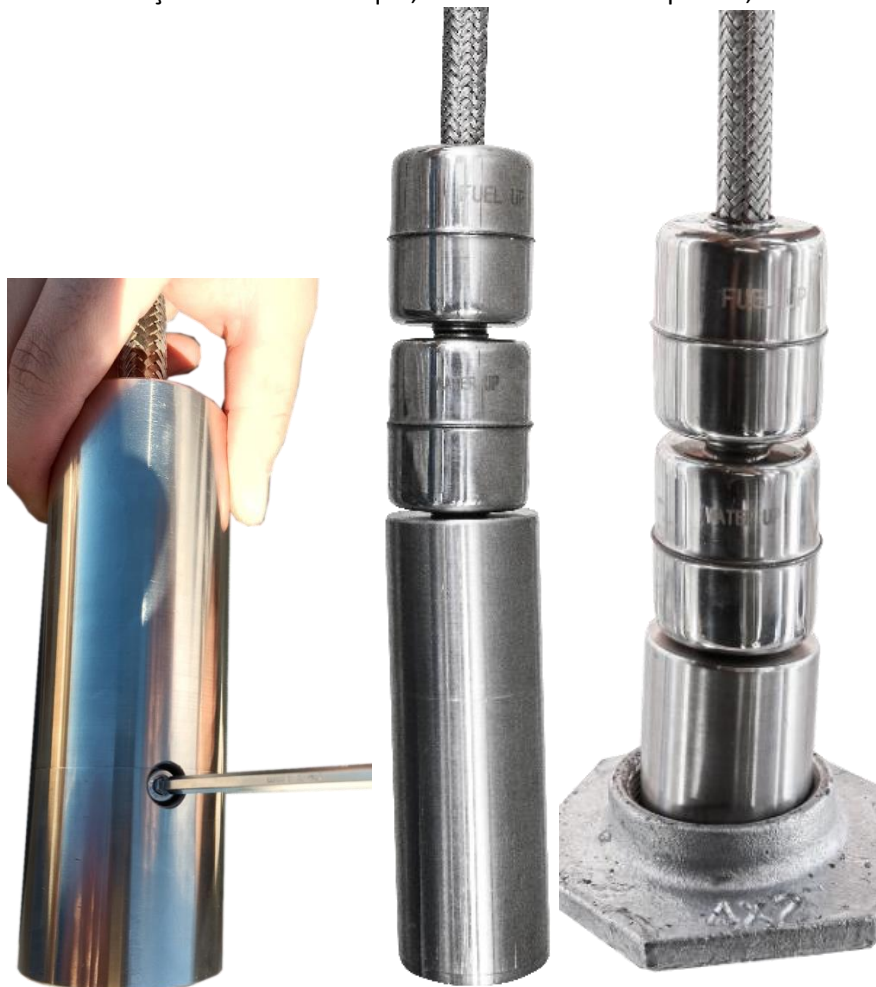
Figura 4 - Posicionamento do peso e das bóias antes da inserção no tanque
