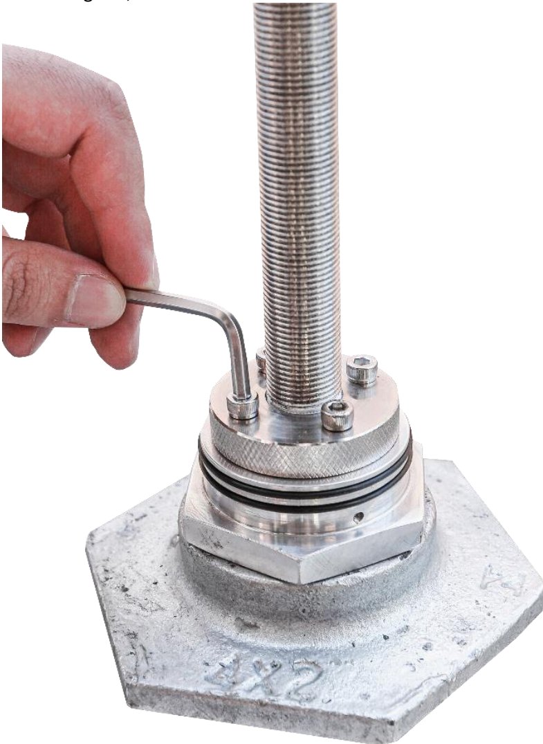
Figura 14 - Aperto dos parafusos de fixação da porca de ajuste
