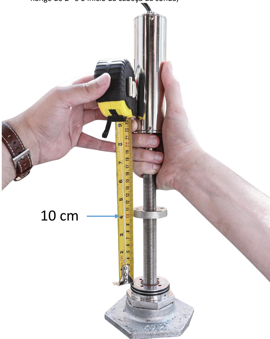
Figura 11 - Ajuste de altura com relação ao fundo do tanque
